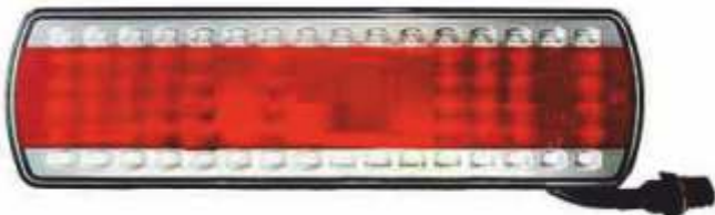
112.08.69-04 фонарь задний, правый, с «бегущим» указателем поворота, жгут с разъемом 7-конт. AMP
