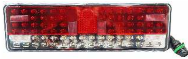
РУФС.09-06 LED 12В фонарь задний, левый, с жгутом, 7-pin разъемом AMP
