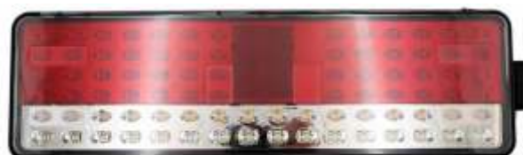
РУФС.09 LED 24В фонарь задний, левый, с боковым 6-pin разъемом
