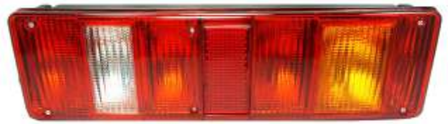
8512.3716-01 без ламп, фонарь правый, доп. бок. габарит, со жгутом, разъем СЦАЗ
