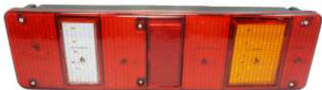
8512.3716-01 LED 24В фонарь задний, правый, доп. бок. габарит, со жгутом, разъем СЦАЗ
