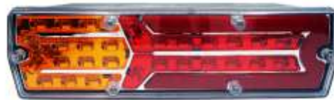
ФП 130В-05 LED/NEON 24В фонарь левый, тюнинг
