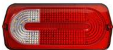
132.3716-500 LED тюнинг Люкс 12В фонарь задний
