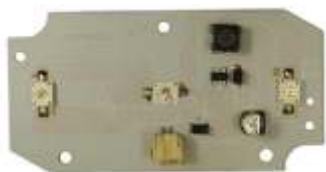
5490.3711 24В LED-модуль указателя поворота, желтый,
