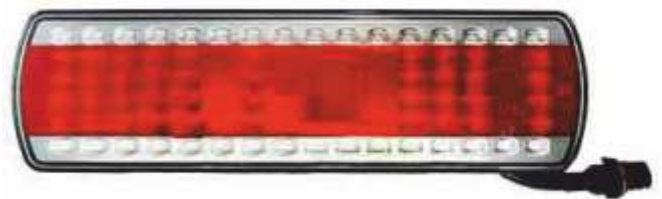
112.08.69-02 фонарь задний, правый, жгут с разъемом AMP 7-контактным
